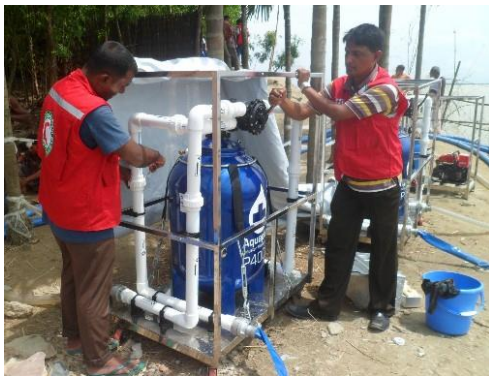
Bangladesh の洪水災害で出動したキット。写真左は浄水装置、1 時間に最大 4,000 リットルの浄水が可能。 簡易水道 (写真右) を接続して供給 ©IFRC
